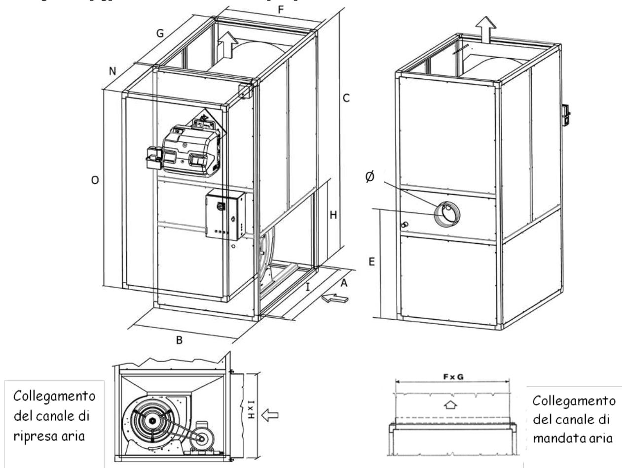
La griglia dell'aria è a SINISTRA fino al modello AS COND EX 200 e a DESTRA dal modello AS CONDEX 250 fino al modello AS COND EX 600. DESTRA e SINISTRA si intendono rispetto al lato bruciatore. Nel disegno la ripresa è a DESTRA - La posizione della griglia può essere invertita.
