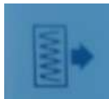
Fig.73: icona segnalazione filtri sporchi / dirty filters warning icon
