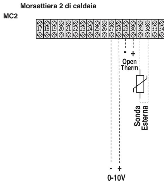
**COLLEGAMENTI PER IL FUNZIONAMENTO IN RISCALDAMENTO E PRODUZIONE ACQUA SANITARIA CON VALVOLA MIX**
