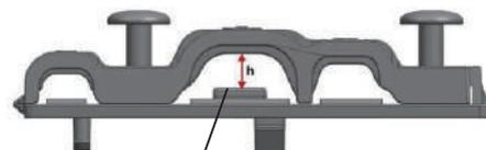
Quando il cavo non viene fissato abbastanza bene, utilizzare la fibbia per sostenerlo, in modo che possa essere bloccato saldamente.
