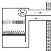
**C32** L'aspirazione dell'aria e l'evacuazione dei prodotti della combustione avvengono per mezzo di un condotto verticale coassiale.
