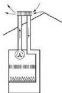
**C42** Apparecchio collegato ad un sistema di condotti collettivi costituito da un condotto per alimentazione aria comburente e un condotto per evacuazione prodotti della combustione. Gli orifizi di questo sistema sono concentrici oppure abbastanza vicini da essere esposti a condizioni di vento paragonabili.
