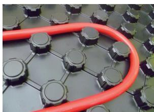
Pannello in polistirene espanso rivestito con lamina di elevato spessore (0,6 mm) che sporge su entrambi i lati per consentire un accoppiamento perfetto tra i pannelli al fine di adempiere alle richieste della UNI EN 1264-4 per quanto riguarda i ponti termici. Passo multiplo di 5 cm.
