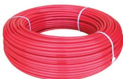
La tecnologia di fabbricazione del tubo PE-XA permette di ottenere una reticolazione  $\geq$  del 75% durante il processo di produzione del tubo (mediante l'aggiunta di perossido) non sono quindi necessari altri trattamenti successivi.
