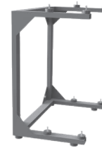
MENSOLA APERTA PER N. 2 UNITÀ ESTERNE BOOSTER MOD. HR 3.0 - 7.8 COMPLETA DI ANTIVIBRANTI
