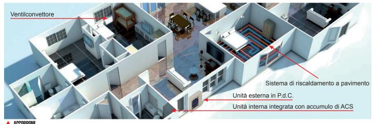
Pompa di calore inverter splittata aria/acqua per produrre riscaldamento, condizionamento ed acqua calda sanitaria per piccole/medie utenze
