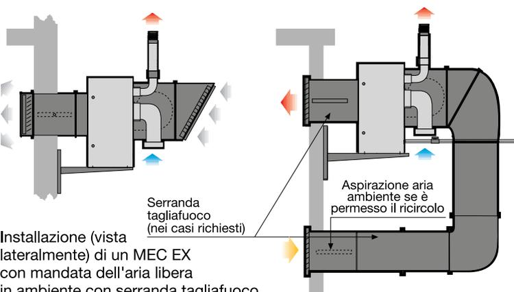
Installazione (vista lateralmente) di un MEC EX con mandata dell'aria libera in ambiente con serranda tagliafuoco e griglia a doppio ordine di alette orientabili, ripresa 100% aria esterna con predisposizione per filtro, scarico prolungato con condotto completo di fascetta e guarnizione. Installazione realizzata con i seguenti accessori:
