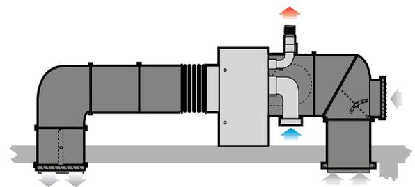
Installazione a tetto (**ROOF TOP**) vista lateralmente di un MEC 57 EX con mandata dell'aria canalizzata con serranda tagliafuoco e giunto antivibrante. Ripresa dell'aria canalizzata interna ed esterna con serranda di taratura. Per collegare il canale di ripresa al canale in dotazione è necessario smontare la griglia che può essere utilizzata per la ripresa aria in ambiente. L'installazione è stata realizzata con i seguenti accessori:
